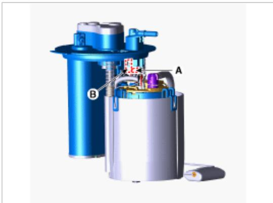
3. 拆卸固定夹(B)，并分离燃油供油管快接连接器(A)。
