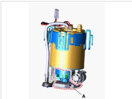
8. 拆卸固定夹(A)，然后拆卸辅助泵总成(B)。
