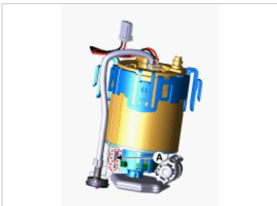
7. 释放固定挂钩后，拆卸自由滤清器(A)。
