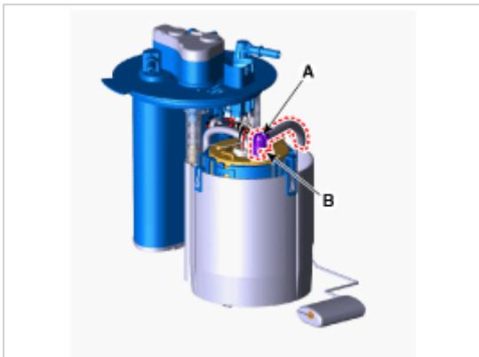
4. 拆卸缓冲管固定夹(A)，然后从储油杯分离头部总成(B)。
