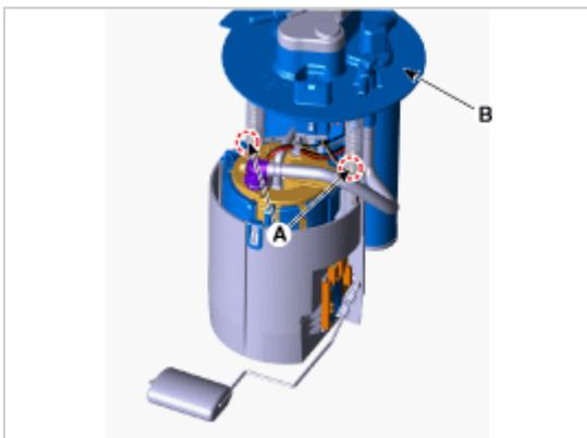
5. 释放固定挂钩(A)后拆卸储油杯(B)。
